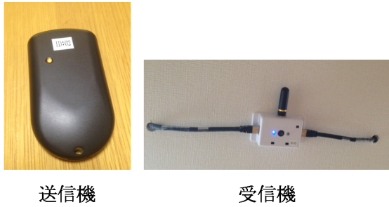
図 4 位置管理システムの受信機および送信機の様子
