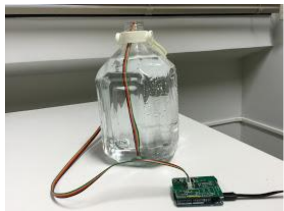
図 8 水位センサの特性評価実験
