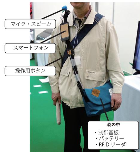
図 2 開発したシステムを装着した様子
