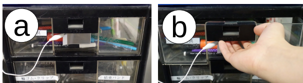
図 25 (a): タッチセンサが貼られている棚 (b): 棚を引く際、タッチセンサに手が触れる様子
