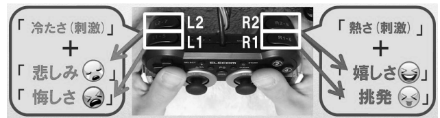
図 2 温度伝達機能の使用法 Fig. 2 Usage of the temperature transmission function.
