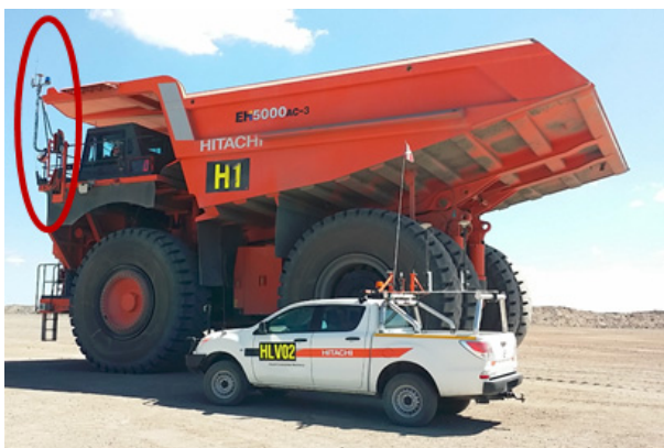
図 3 左前にアンテナを取り付けた重機
