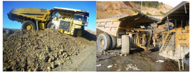
図1 鉱山用大型重機どうしの衝突事故現場 [1], [8]
