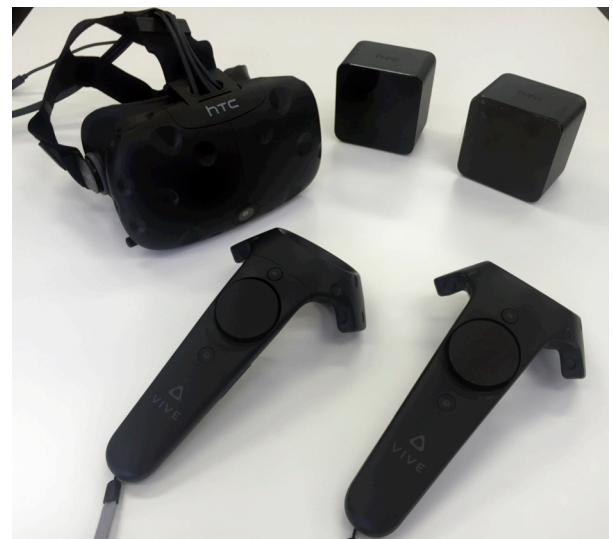
図2 使用したVR機器（HTC Vive） 左奥：ヘッドマウントディスプレイ 右奥：ベースステーション 手前：コントローラー
