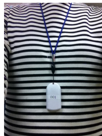
図 4. BLE モジュール子機の装着の様子
