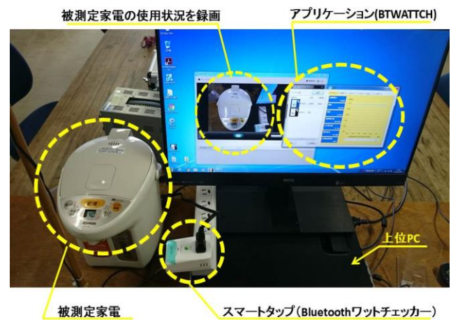
図3 被測定家電の消費電力量の測定風景
