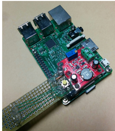
図 2 内部基板 昇圧基板,LED, スイッチ, センサー (左部裏側)
