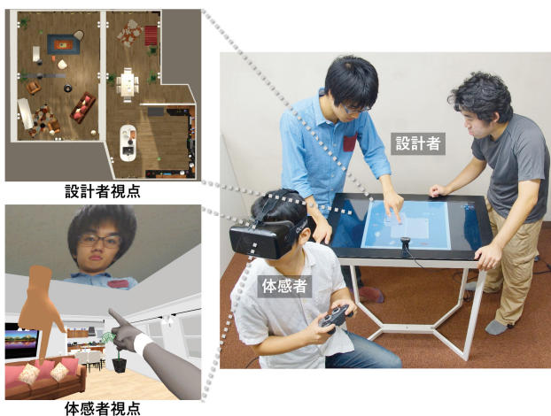
図 1 Dollhouse VR を使用しているユーザの様子 (右)。左上図は設計者の見る俯瞰視点、左下図は体感者の見る一人称視点である Fig. 1 Dollhouse VR interface (right) for collaborative design discussion. Top-down view for designers (upper left) and immersive view for occupant of space (lower left).
