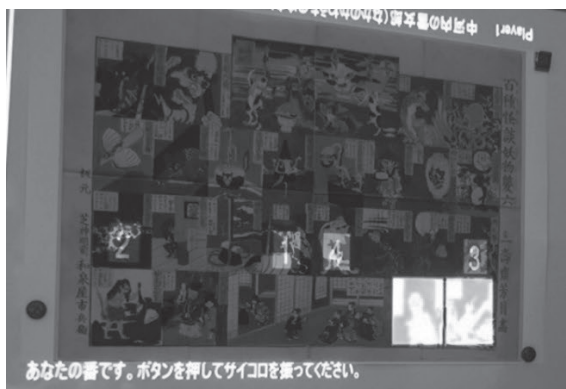
図 6 プロジェクタによる行き先の重畳表示 Figure 6 Augmented display of next positions of players by a projector.
