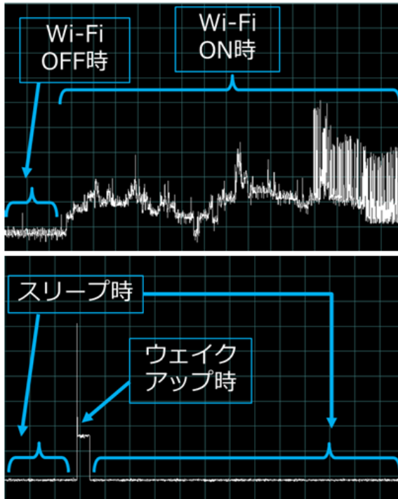
図 7 ウェイクアップ時の電流波形 ON/OFF 制御(上), SLEEP/Wake-up 制御(下)
