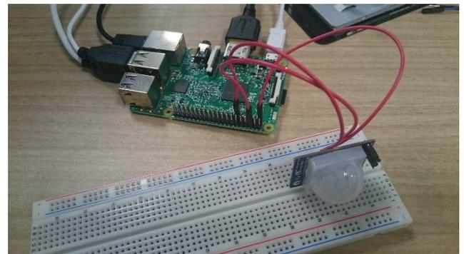
図 5 Raspberry Pi に、センサとして PIR センサを接続して構成した Bot
