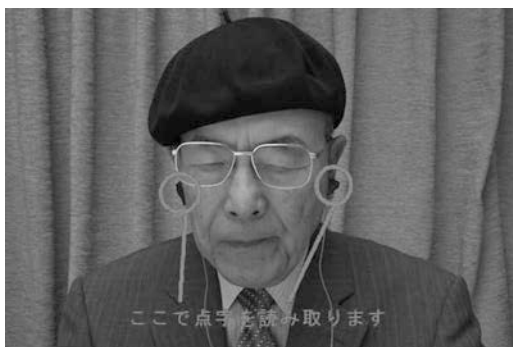
図3 振動体は腕や耳などに付けることができる(2点式体表点字の例)
