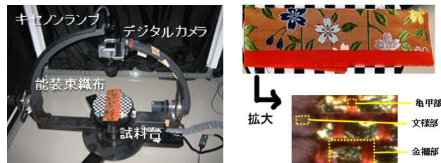
図3 OGMによる多方向照明画像計測と計測対象物
