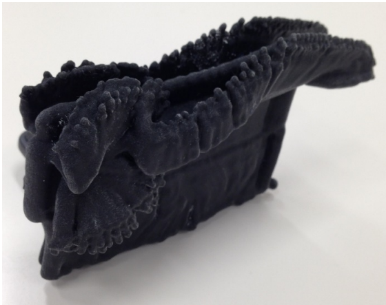
図 1 3D プリンタで出力された motion sculpture の例 (後述の動きデータ A) . 人体の動きは、能の動きの一部を演者が演じたものを、モーションキャプチャシステムで計測したもの . 演者は、写真の物体の左端から動き始め、右端まで移動しながら、手を前方に振り出している .
