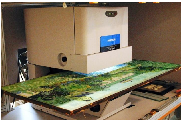
図 8 X線分析顕微鏡による非破壊分析装置
