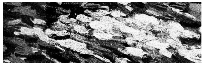
図 12 鉛元素のマッピング像
