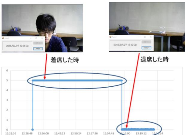
図9 マットセンサの在席状況の検証
