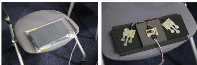
(a) デバイス外観 (b) 内部の圧力センサ
