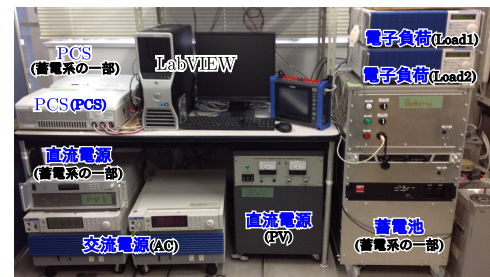
図 1 住宅内電力システムの構成 (上) と実機シミュレータの外観 (下)。上図はシステムの構成及び電力の流れを表しており、環境の変化に影響を受け制御不可能な機器を赤、制御可能な機器を青で示している。下図は住宅内電力システムを実機により構成したシミュレータであり、括弧内に上図の機器との対応を示している。
