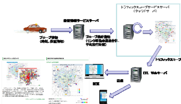
図5 オンラインシステムの構成
