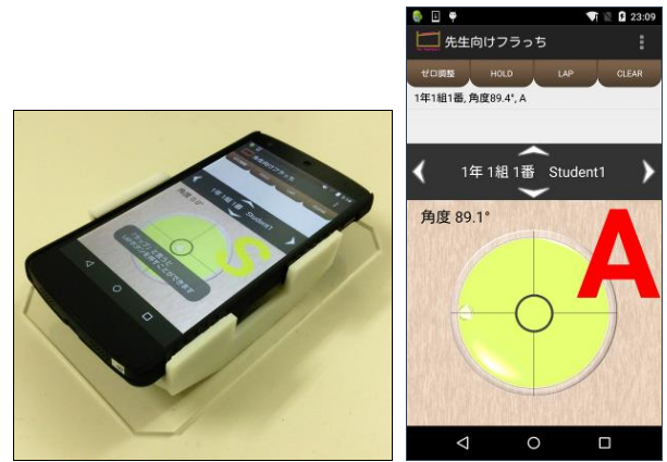
図5 角度計測機能の動作例
