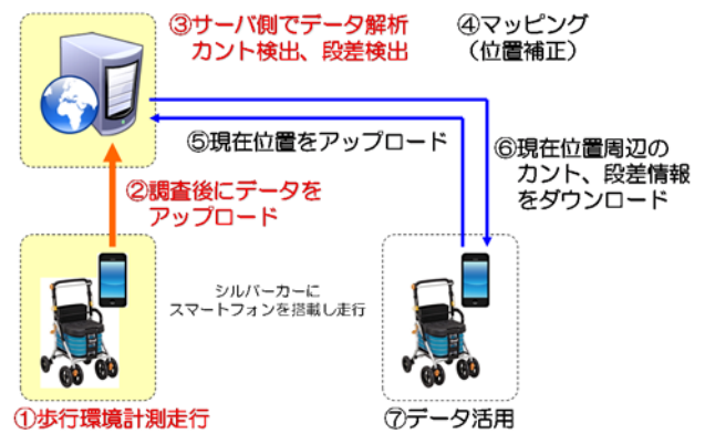
図2 歩行環境計測・利用システムの構成
