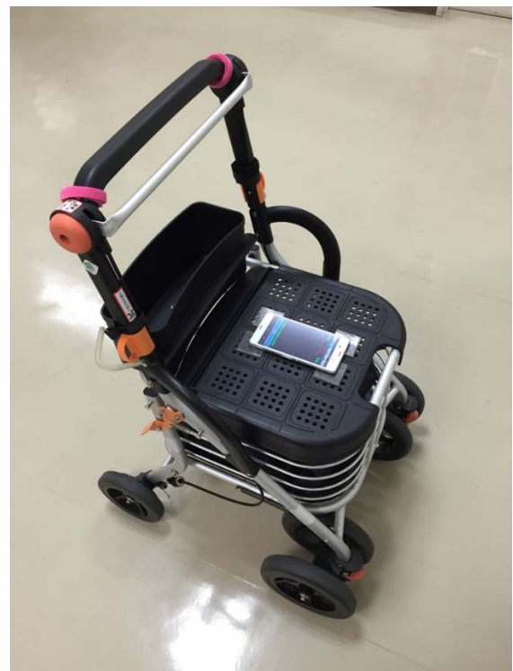
図4 歩行環境データ取得時のシルバーカーへのスマートフォンの設置
