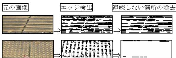
図3 誘導ブロックと警告ブロックの画像処理
