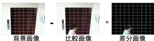
図3 ブロック画像での差分処理
