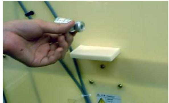
図 2: RFID タグの読み取り距離の測定
