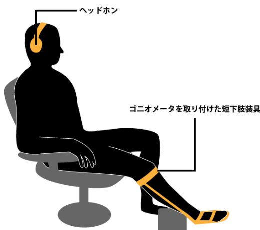
図3 実験では実験参加者は椅子にかけた状態で利き足を高さ約15cmの台にのせる。実験参加者はゴニオメータなどを取り付けた短下肢装具を利き足に装着し、頭にはヘッドホンをかける。実験実施者の指示で短下肢装具を装着した側の脚の足関節を底背屈運動する。
