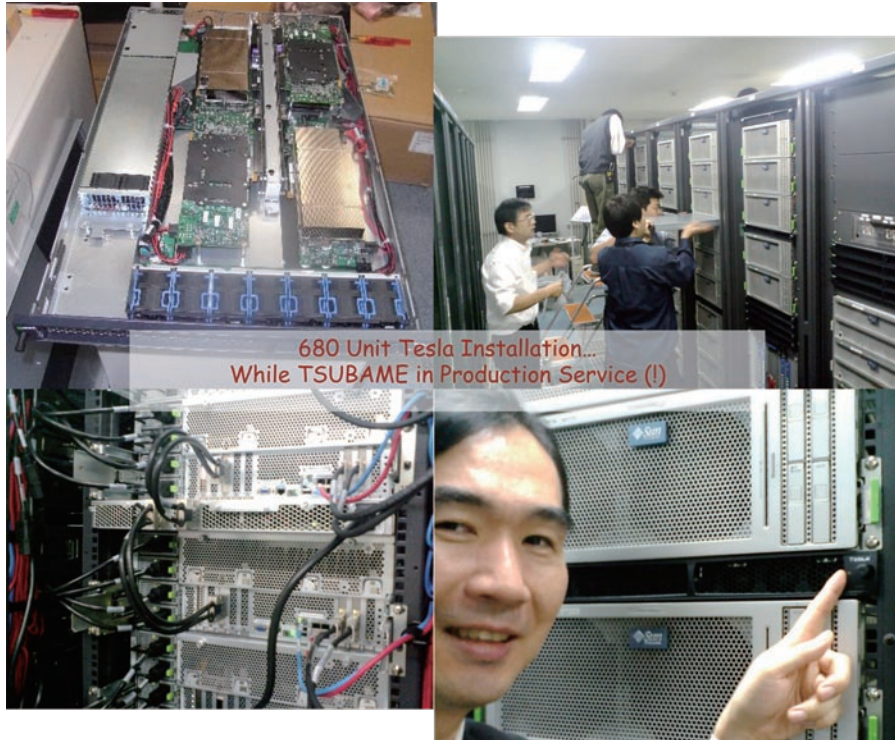
図-3 TSUBAME への NVIDIA Tesla S1070 の追加。それぞれの S1070 には Tesla 10p プロセッサカードが 4 枚内蔵されている。TSUBAME の計算ノード間に S1070 を挿入し、PCI-Express の拡張ケーブルで計算ノードに接続する。挿入後もほとんど目立たず、アクセラレータの高い計算密度を示している (写真は筆者)。
