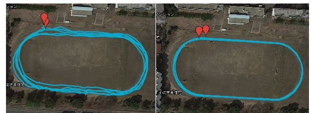
図 10 従来の GPS で測位した結果 (左) と、準天頂衛星「みちびき」の L1-SAIF 信号で測位した結果 (右) の比較
