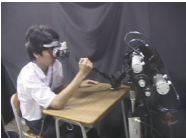
図3: バーチャル腕相撲システムの外観
