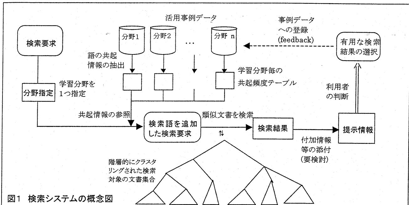
図1 検索システムの概念図
