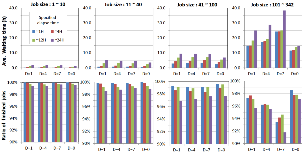
図 5 一定間隔で保守を実施した場合の実行待ち時間とジョブの終了割合
