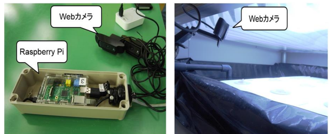
図1：画像取得方法(左:機器 右:設置様子)
