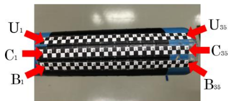
図3 ラインカメラで読み取る格子の特徴点
