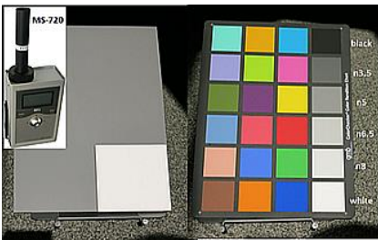
図3 分光放射計(MS-720), 標準グレーカード, 標準白色板, カラーチェッカー(24パッチ)の写真
