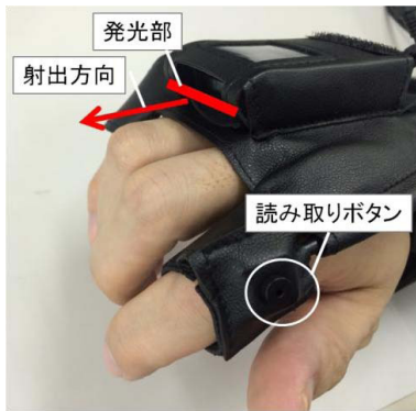
図 4 グローブ型スキャナの装着例
