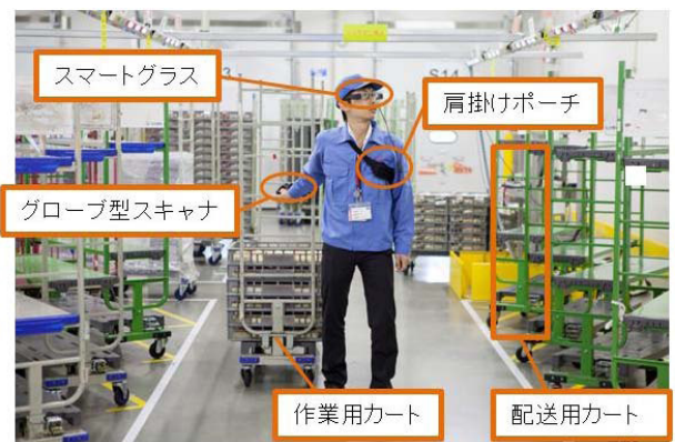
図9 ウェアラブルデバイス利用時の作業風景 Fig. 9 Distribution work scene with Wearable Device.
