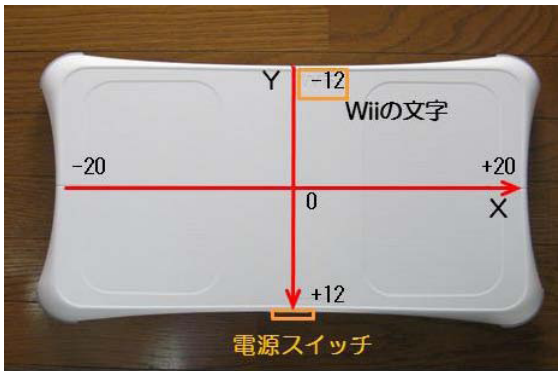
図 5 バランス Wii ボードにおける重心のスケール Fig. 5 Scale of the balance in the balance Wii board.
