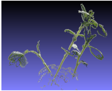
図 8 PMVS2 で植物を 3 次元復元した結果
