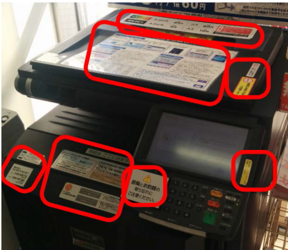
図 3 調査例：コンビニエンスストアにおける MFP の使用例。四角で囲まれた領域は、後から設置された操作方法の説明
