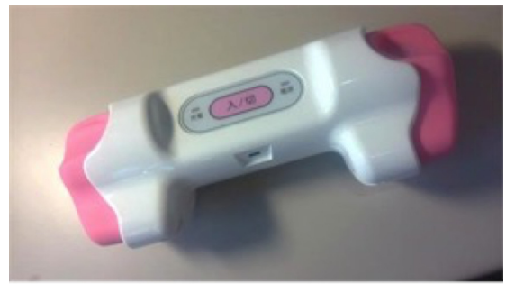
図 2 上肢把持動作計測用コントローラ (システムインスツルメンツ株式会社)
