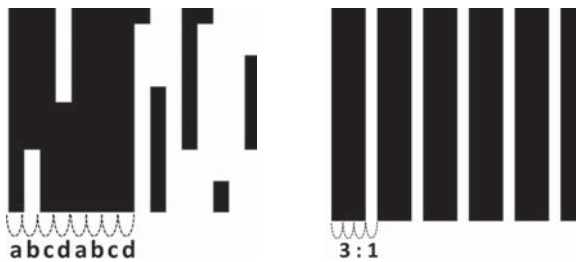
4種類の絵を表示する A 4種類の絵を表示する B 図 2 スキャニメーションの仕組み
