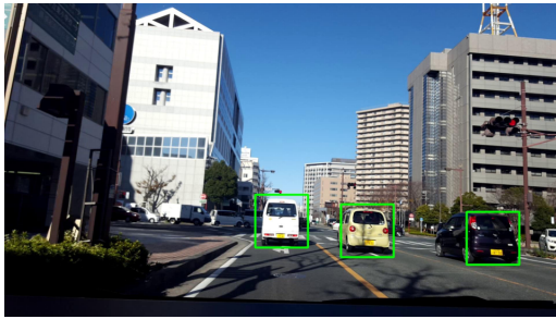
図 10: 画像認識による車両検出例
