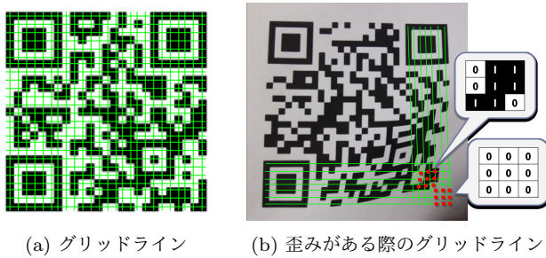
図 1 QR コードの一般的な復号方式
