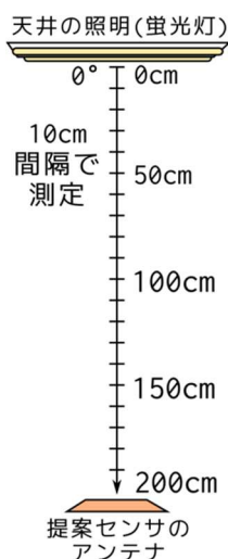
図 19 照明の影響調査測定の実験環境
