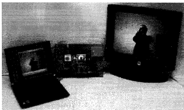
図4 C-MOS イメージセンサカメラからの映像配信の例 右：NTSC モニタ（イメージセンサの映像をNTSC出力） 左：ノートPC（QuickTimeによるストリーミング再生）
