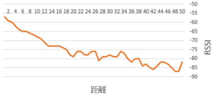
図 5: ビーコン 1 個の場合の測定結果
