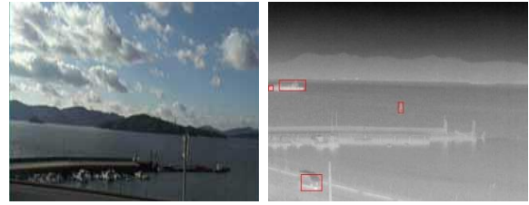
(a) 監視対象領域 (b) サーマルカメラ画像を対象に物体領域を検出した結果
