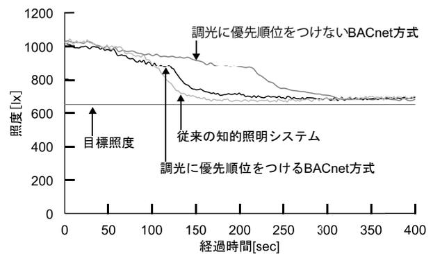
図4 シミュレーションでの目的照度への収束に要する時間
