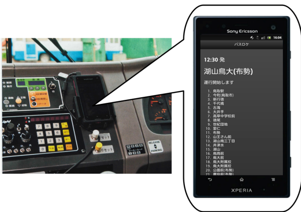
図2: 実際に車載機として用いているスマートフォン
